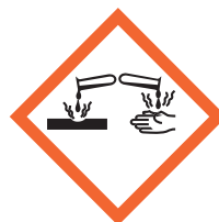
Figura 2: se l'etichetta indica che il prodotto è «causticante», aumentano i rischi di affezioni per la pelle. Proteggere la pelle, in particolare modo mediante l'uso di guanti idonei, diventa quindi un obbligo.
